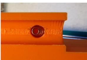
Damit die Lötpitze nicht zu schnell abnutzt, wird über ein Federkontakt (verbunden mit A0, nicht im Schaltplan eingezeichnet!) ermittelt ob die Spitze in Ruhestellung ist. Die Klinkenbuchse muss aus Metall sein und über das Kabel mit Masse verbunden sein. Ist die Lötpitze eingehängt, so wird die Temperatur auf 50°C begrenzt. Da die Station in wenigen Sekunden aufheizt, muss bei Löten nie gewartet werden.
