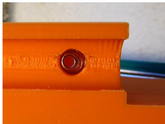
Danach wird eine Feder aus einem Batteriehalter recycled. Die Feder wird mit einem Stück flexiblen Draht (10cm) verlötet und mit einem Stecker (Buchsenleiste, Stiftleiste an der Platine) versehen. Dann wird die Feder zusammengedrückt und wie auf dem Bild in das Gehäuse eingefügt. Der Draht wird durch das Loch nach innen geführt.
